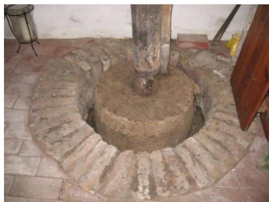
96. kép: A kősúlyos bálványprés padlóba engedett kősúlya (Budajenő)
