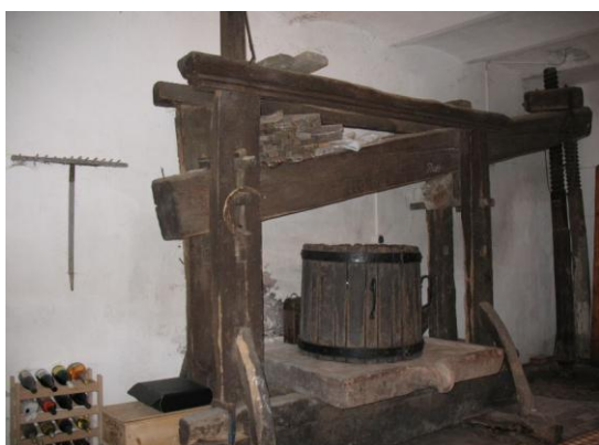
95. kép: Kősúlyos bálványprés (Budajenő)
