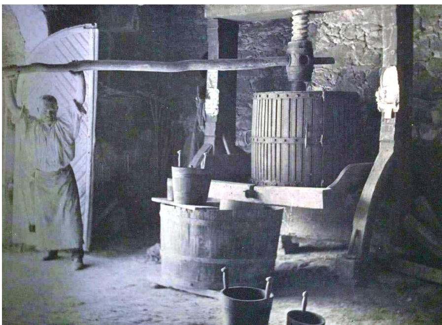
98. kép: Alulhajtós, középorsós sajtó működés közben Budaörsön (JBH szolo 33)
