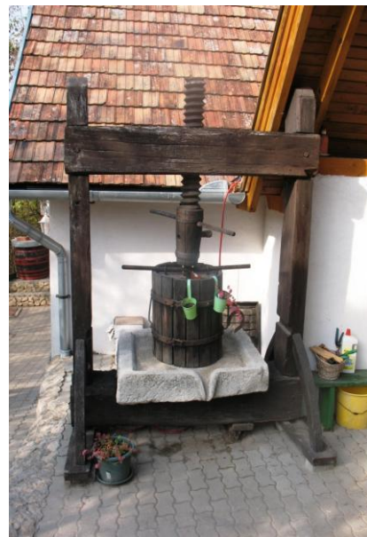
100. kép: Középsős, aluhajtós sajtó egy biatorbágyi présház előtt
